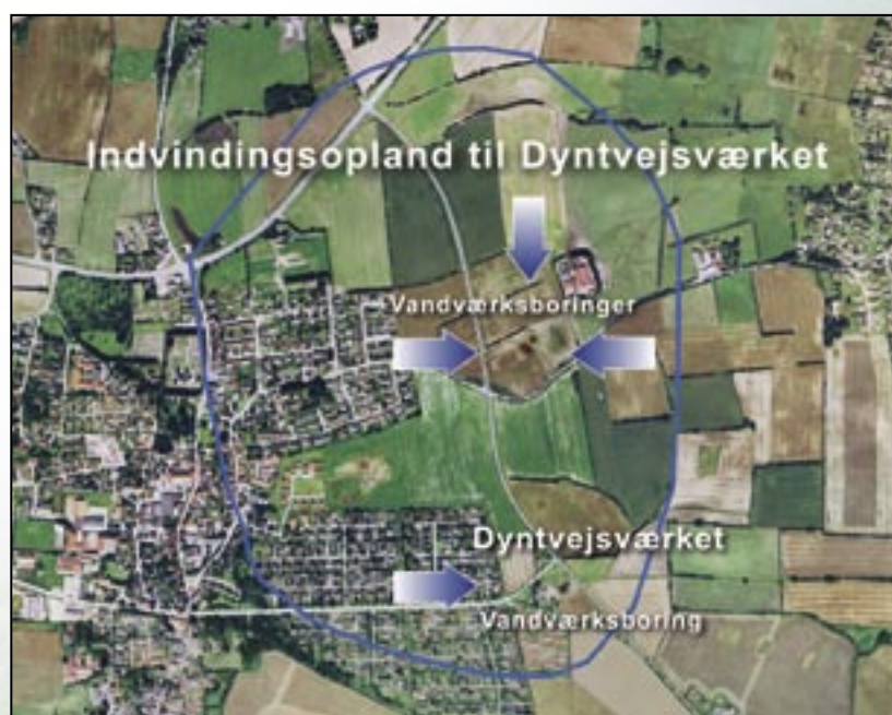
Figur 7 Indvindingsopland (areal ca. 130 hektar). Pilene angiver grundvandets strømningsretning.
