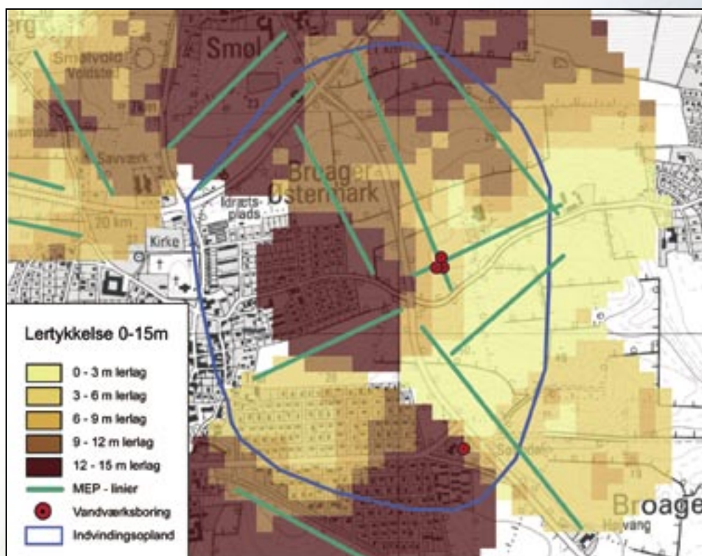
Figur 17 Lertykkelser i indvindingsoplandet til Dyntvejsværket
